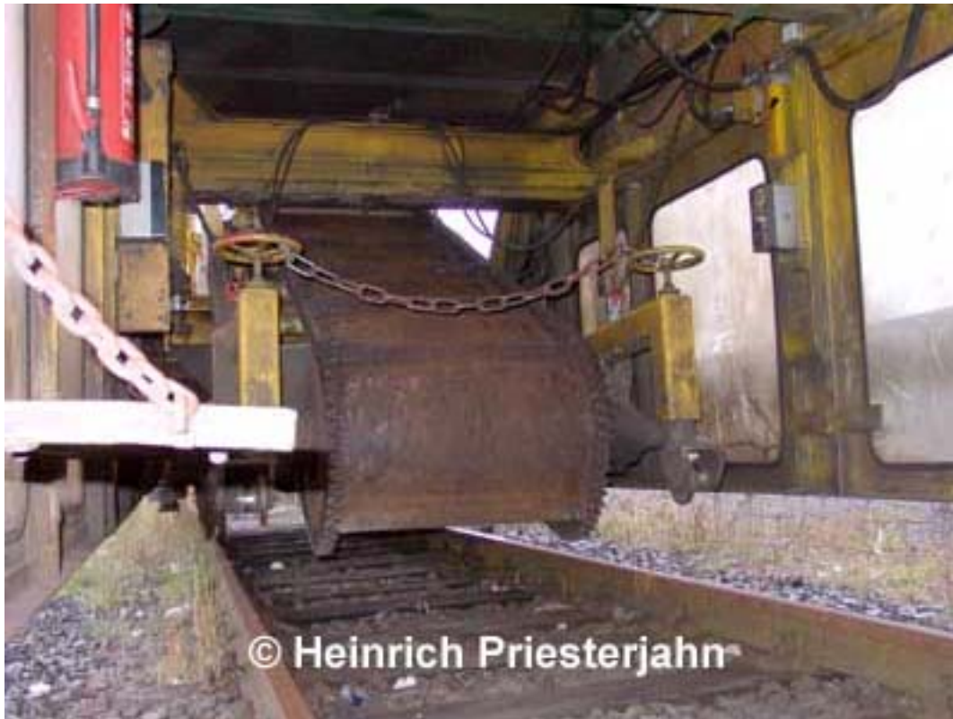
Obrázek 6: Detail stoje SUM 1000 –těžební hlava [6].
