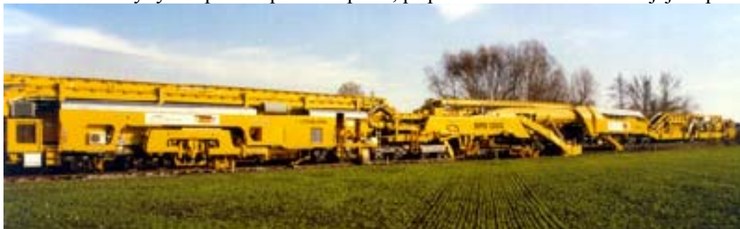
Obrázek 7: Stroj na obnovu zemní pláně SUM 1000 [6].
