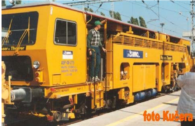
Obrázek 5: Strojní podbíječka ASP 80 [6].
