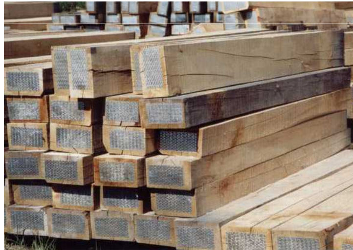
Pražce na skládce před impregnací (zdroj JDZ Soběslav)
